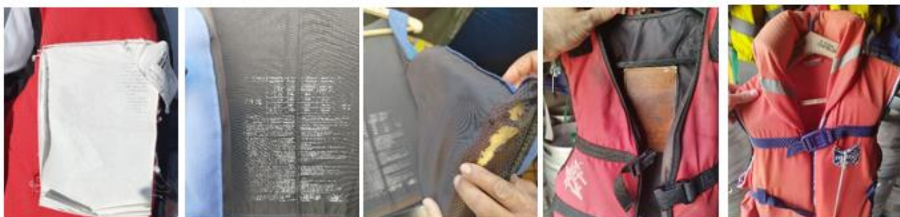
Gilet d'aide à la flottabilité ne répondant plus aux normes en vigueur suite à un contrôle (de gauche à droite : 1-marquage des conditions d'usage effacé ; 2-marque « CE » effacé ; 3-gilet déchiré ; 4-gilet ayant une norme abrogée, 5-gilet n'ayant réussi le test de flottabilité annuel
