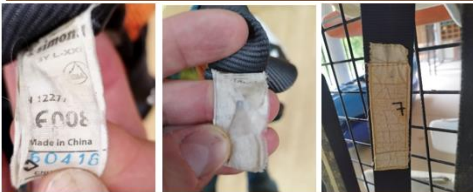
Lot de harnais dont les marquages « CE », la référence de la norme ou les conditions d'utilisation sont effacées
